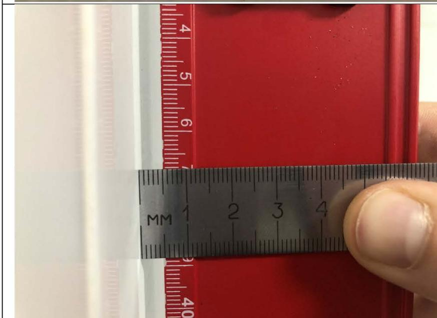
Фото №66. Измерение уровня стен ванной комнаты в квартире.
